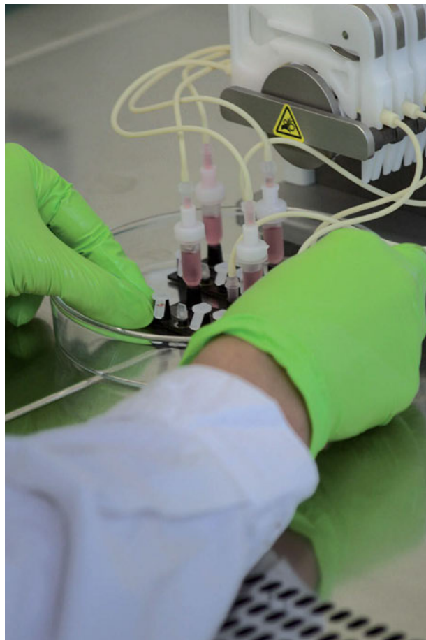
Die Organ-on-Chip-Testsysteme von Dynamic42 haben Kammern, die sich mit Zellen, Medium oder Testsubstanzen fluten lassen. Fotos(2): Dynamic42
