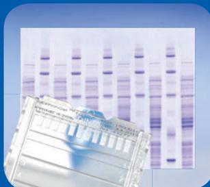
Fertiggele für die vertikale Minigel SDS PAGE
