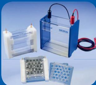
Elektrophoresekammer mit optionalem Tankblotmodul
