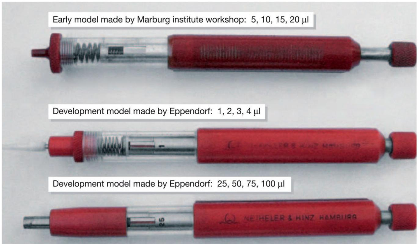
Mit Heinrich Schnitgers Prototyp als Vorlage konstruierte die Werkstatt des Instituts für Physiologische Chemie der Universität Marburg ab 1957 Kopien von Schnitgers Mikropipette. Die Firma Netheler und Hinz, die ab 1962 unter dem Namen Eppendorf firmierte, entwickelte diese weiter (mittleres und unteres Modell) und brachte 1961 mit der Marburg-Pipette schließlich die erste kommerzielle Mikropipette auf den Markt.
