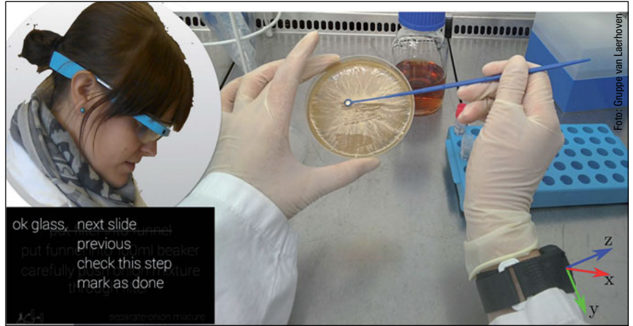
Ein Beschleunigungsmesser am Handgelenk und eine Datenbrille registrieren die einzelnen Handgriffe eines Experiments und zeichnen sie auf. Das System soll so erkennen, welchen Teil des Protokolls der Experimentator gerade bearbeitet.
