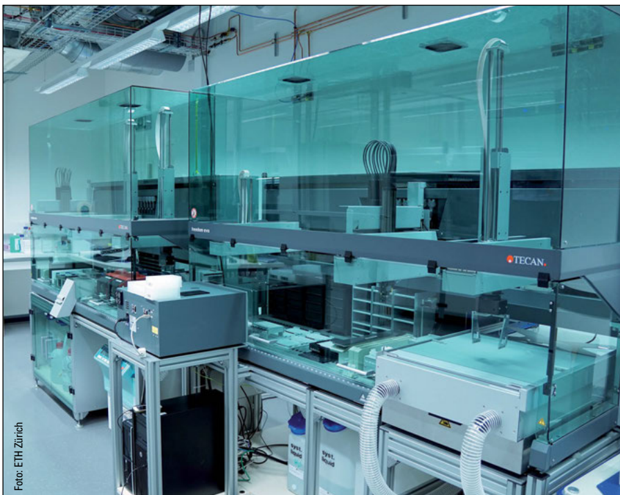
Für ein Standardlabor eine Nummer zu groß: Das Roboter-System der Zürcher Laboratory Automation Facility für die automatische Kultivierung von Mikroorganismen.
