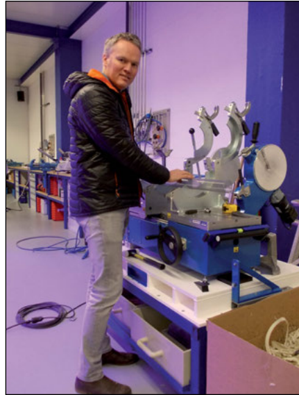
MINT-Geschäftsführer Gunnar Mühlstädt demonstriert die Maschine, mit der die Kunststoffrohre verschweißt werden.
