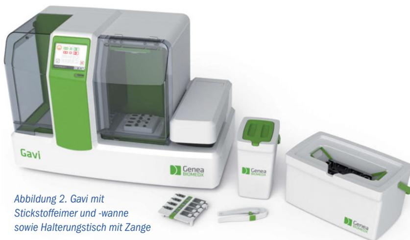
Abbildung 2. Gavi mit Stickstoffeimer und -wanne sowie Halterungstisch mit Zange
