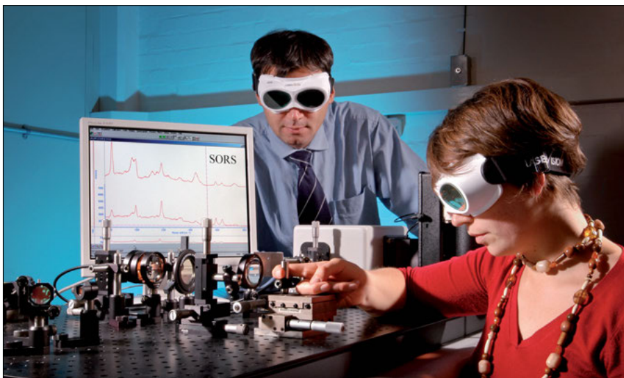
Zwei Forscher untersuchen mit der Raman-Spektroskopie Variante SORS (Spatially Offset Raman Spectroscopy) die Knochendichte.
